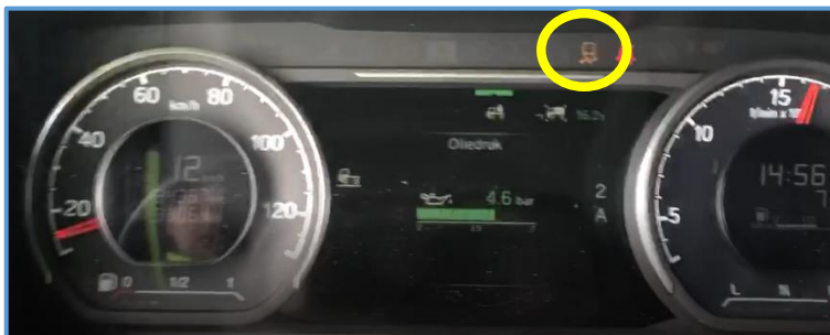
Vermogensreductie tot 55 km/h vanwege constante wielslip bij onbeladen combinatie.
