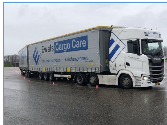
Geschaarde-Situatie na 4 meter achteruit rijden vanuit bovenstaande bochtpositie. Onmogelijk voor chauffeur om iets aan deze situatie te veranderen wanneer trekker + 1 e oplegger binnen normale rijbaan moeten blijven (bijvoorbeeld rotonde) - stressvol
