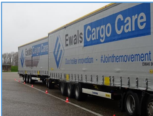
Geschaarde-Situatie na 8 meter achteruit rijden door Ewals chauffeur vanuit strakke rechtuit positie. Lastig en vereist concentratie en regelmatige oefening voor chauffeur
