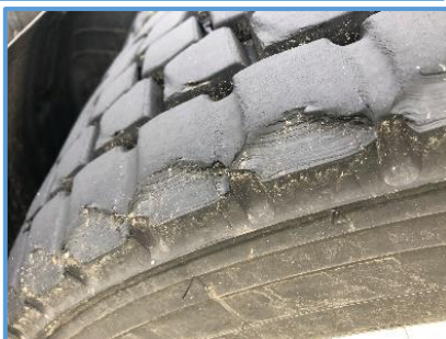
Happen uit rubber en beschadigingen aan banden aandrijfjas van bijna nieuwe trekker
