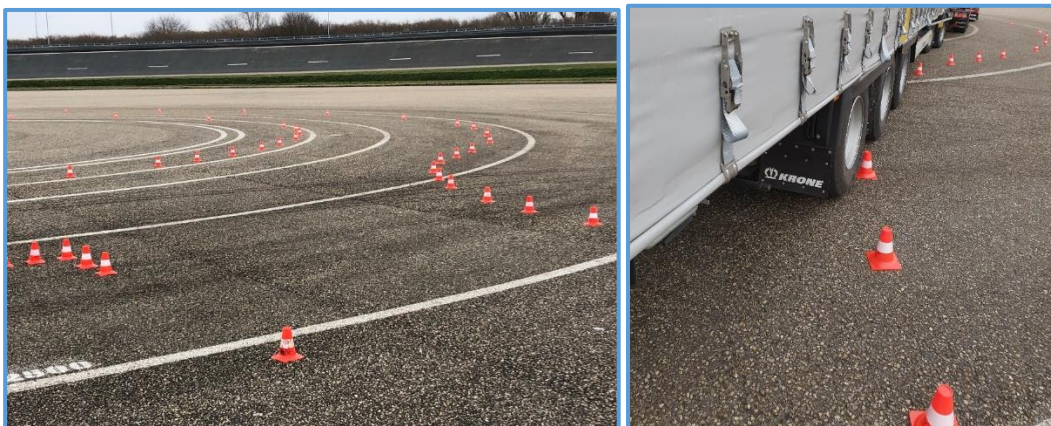
Uitgezette N556 rotonde overschrijding naast rijbaan bij oprijden van de rotonde
